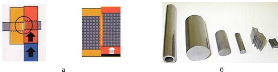
Рис. 4. Схема нагружения проката (а) и отрезанные мерные заготовки (б)
